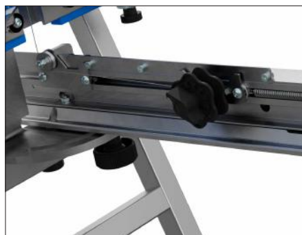
Schneller und werkzeugloser Drahtwechsel dank Vorratsdrahtspule
